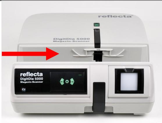
Führen Sie das Magazin von hinten in den Magazinschacht ein
