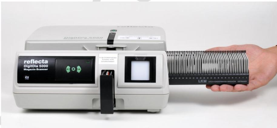
Durch das Gewicht kippen die Magazine ein wenig nach unten und dadurch kann der Scanner unter Umständen die letzten 1 bis 3 Dias nicht einziehen. Unterstützen Sie den Einziehvorgang ein wenig, in dem Sie das Magazin sachte anheben.
