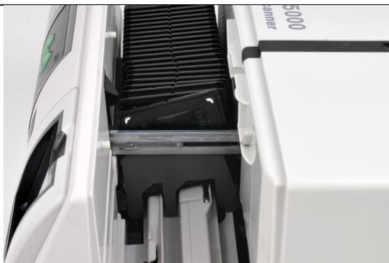
Schieben Sie das Magazin bis zum **Anschlag des Transportschiebers**.
