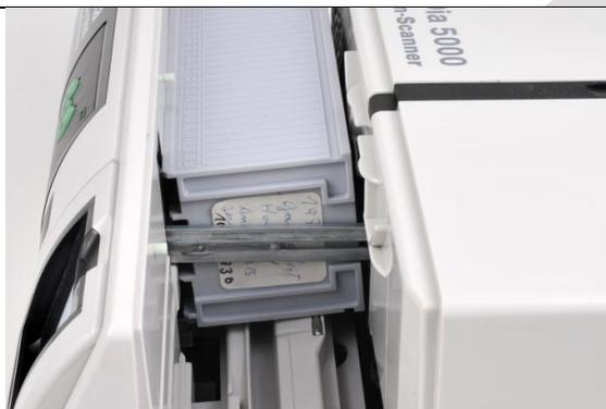
Paximat-Magazine werden mit der Öffnung zum Scanschacht eingeschoben
